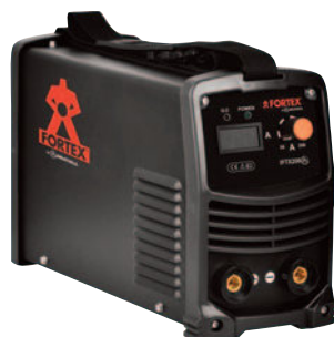
Ref. A066287 MÁQUINA SOLDAR INVERTER MMA IFTX200A FORTEX Regulación de soldar: 20 - 200 Amp. Conector dinse 35/50 mm. Electrodo utilizables Ø 1,6 - 5 mm. Generador compatible: 5,2 / 6,5 KW. Incluye Kit de soldadura y maletín. Peso: 8,3 kg.
