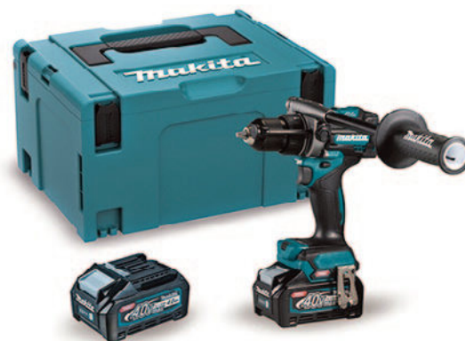
Ref. A064319 TALADRO PERCUTOR XGT® 40VMAX MAKITA Motor BL sin escobillas. Encaje: 1/2". Par de apriete máximo Duro/Blando: 140/68 Nm. Velocidad: 0 - 2.600 rpm. Ajuste del par: 41 / 21. Max Ø perforación en mampostería y acero 20 mm. Capacidad del portabrocas: 1,5 - 13 mm. Peso (con batería 2,5 Ah): 2,7 kg. Peso (con batería 4,0 Ah.): 3 kg.
