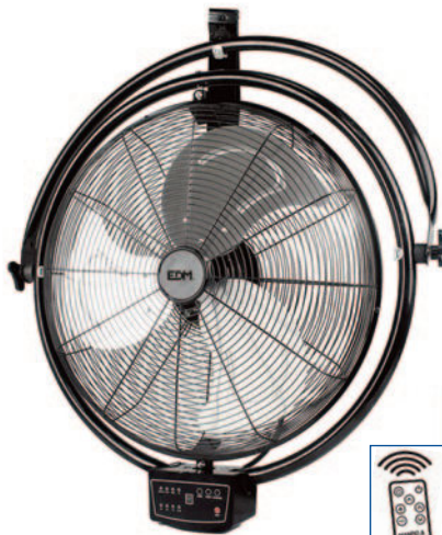
Ref. A069171 33520 EDM 120 W. 3 aspas Ø 50 cm. Altura 82 cm. 3 velocidades. Temporizador 7,5 h. Caudal de aire 5.400 m³/h. 64,9 dB. 74,70€
