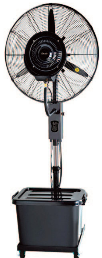
Ref. A069174 NÉBOA FÁCULA 220 W. Motor centrífugo. 3 velocidades. Altura 170-200 cm. Depósito 41 l. Volumen nebulización máx. 5 l/h. Caudal de aire 8.040 m³/h. Nebulización y ventilación independientes. Oscilación ajustable. Temporizador hasta 7 h. Base cuadrada con ruedas. 225,30€
