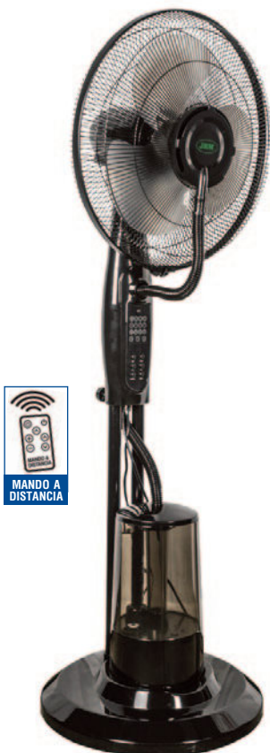
Ref. A069132 5425 JBM 75 W. 3 aspas. 3 velocidades. 3 modos: normal, natural y sleep. Depósito 3,2 L. Volumen de nebulización max. 220 ml/h. Nebulización y ventilación independientes. Temporizador 0,5-7,5 h. 73,50€
