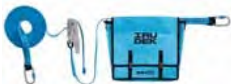
Ref. A047114 LÍNEA DE VIDA X2 IRUDEK Temporal horizontal de cinta certificada para 2 usuarios. Versátil, certificada para ser instalada de 4 modos: (1) Ambos extremos conectados a 2 puntos de anclaje fijos. (2) A 2 puntos de anclaje temporales. (3) Cada extremo de la propia línea abrazando un pilar. (4) Alrededor de una estructura de gran envergadura. 40,70€
