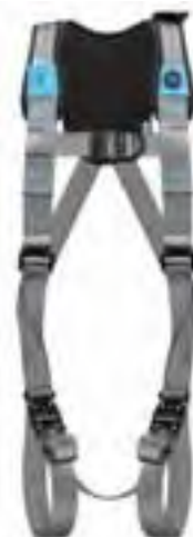
ARNÉS ANTICAÍDAS EXPERT 1 PRO IRUDEK Protección total: anillas dorsal y esternal con extensión en la dorsal. Ajuste rápido: hebillas automáticas K-EASY de acero zincado. Comodidad superior: Espalda y hombros acolchados con tejido RIPSTOP. Ergonomía perfecta: Cintas ajustables en altura y piernas. Estabilidad asegurada: Sistema ANTISLIP para mayor sujeción. Trazabilidad y control: Chip NFC Ready integrado. Ref. A067534 Tallas S-M. Ref. A067045 Tallas L-XXL.
